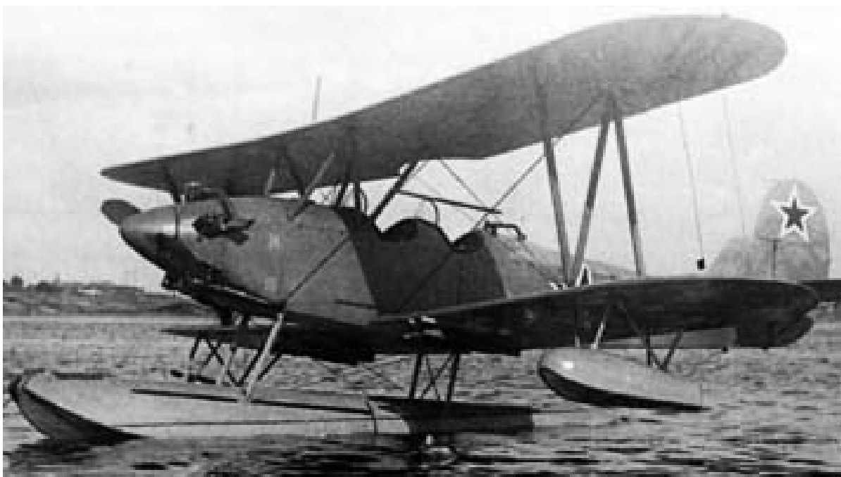
U-2 in einer militärischen Sonderausführung mit Mittelschwimmer, Stabilisatoren, Motorverkleidung und Spinner
