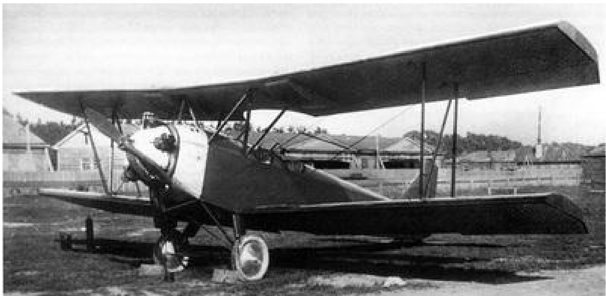
U-2: 1. Prototyp mit Triebwerk M-11, Erstflug am 24.06.1927
